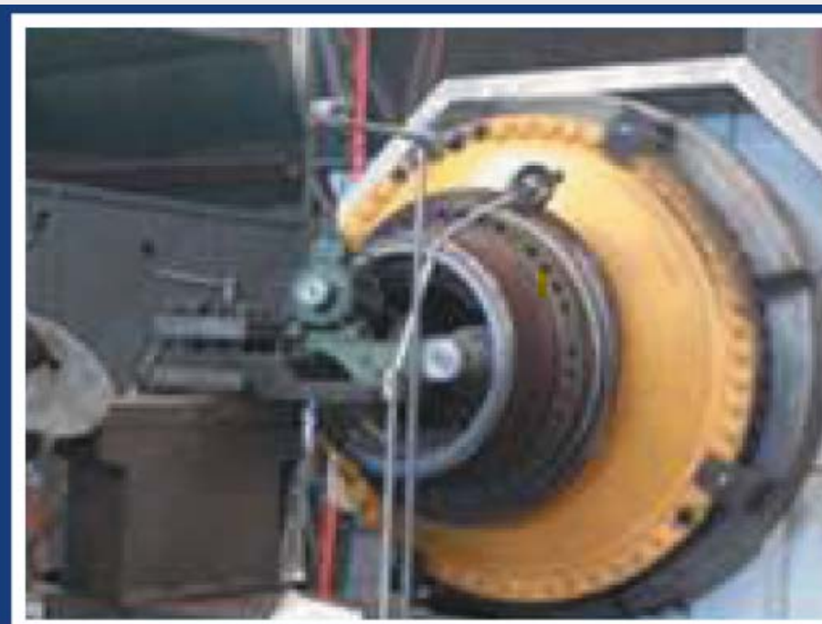
Recuperación dimensional en pistas interiores Cubo Rueda Maquina KOMATSU 930-E. Puesto sobre torno 1.600 mm de volteo sobre bancada, por 3 metros entre punta.
