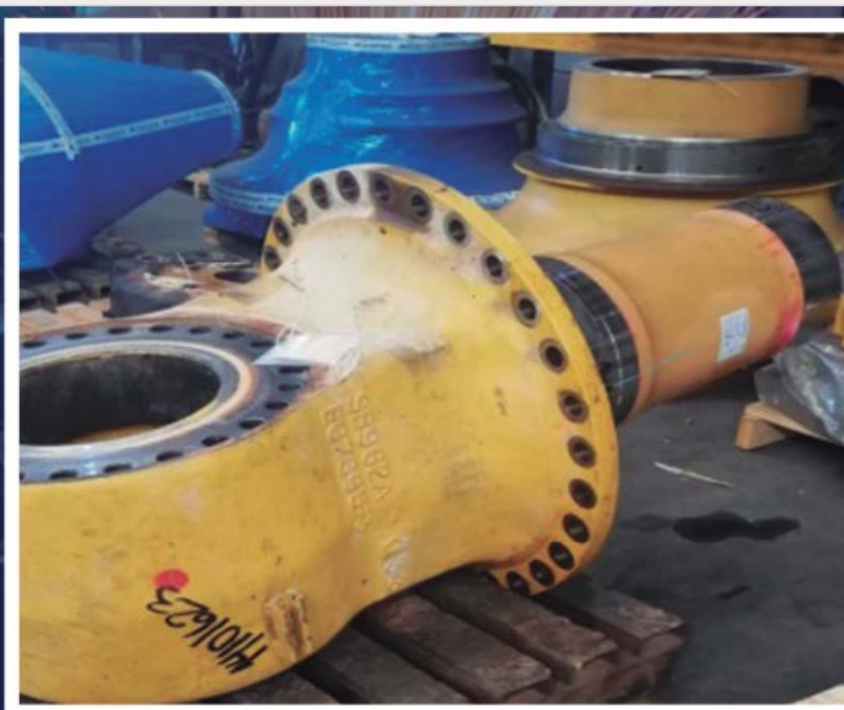
Metalizado Arco Spray y rectificado en pistas de rodamientos exteriores en Muñón KOMATSU 930-E.
