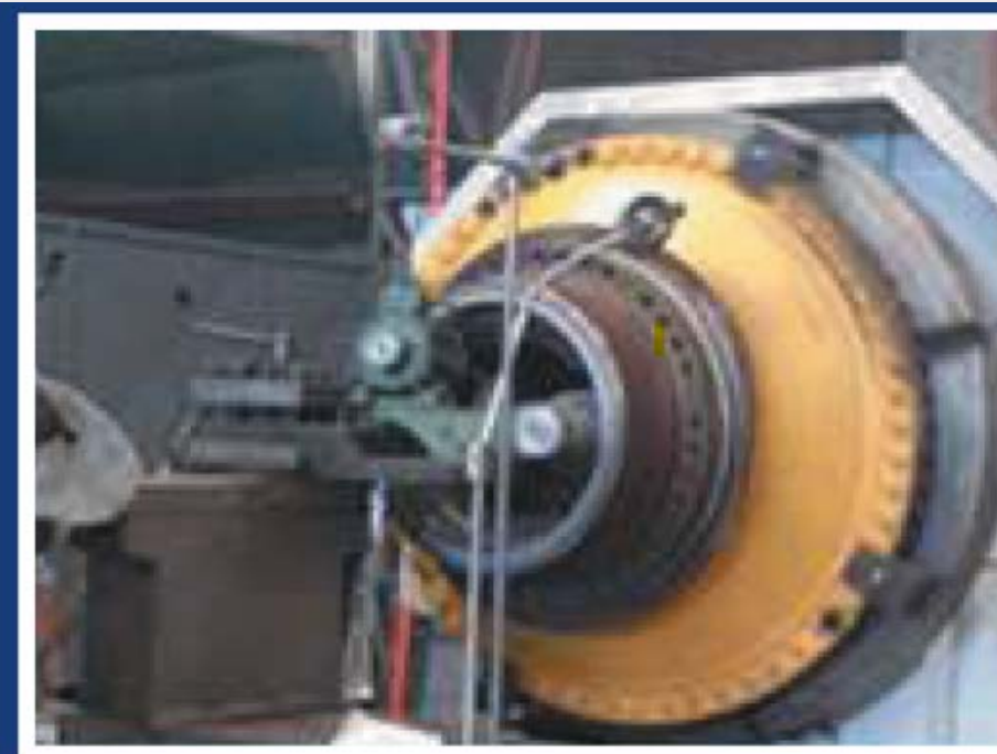
Recuperación dimensional en pistas interiores Cubo Rueda Maquina KOMATSU 930-E. Puesto sobre torno 1.600 mm de volteo sobre bancada, por 3 metros entre punta.
