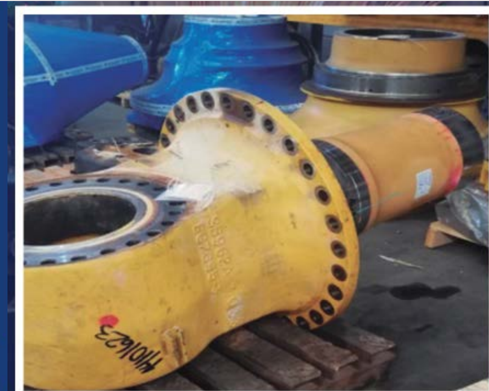
Metalizado Arco Spray y rectificado en pistas de rodamientos exteriores en Muñón KOMATSU 930-E.
