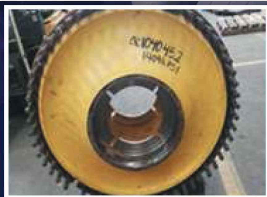
Metalizado Arco Spray y rectificado en pistas de rodamientos interiores en Cubo de Rueda KOMATSU 930-E.
